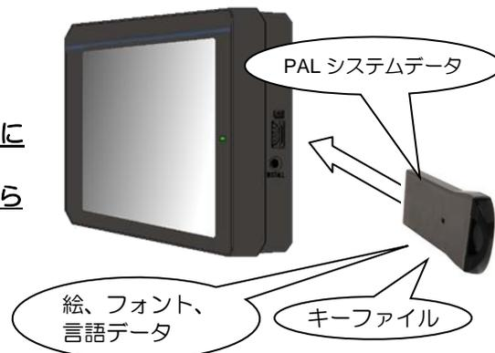
(2) 電源 OFF の状態で USB メモリを PAL に挿入してください。
