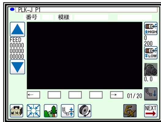
**メモ** 「モータ軸と機械の位置設定」が未設定である場合、右図の設定画面が表示されます。
